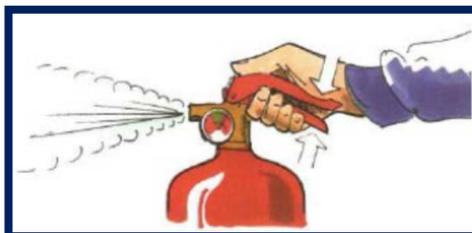
4. azionare l'estintore alla giusta distanza dalla fiamma, compatibilmente con l'intensità del calore della fiamma stessa
