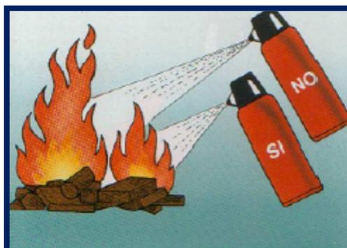
7. Se si tratta di incendio di liquido, operare in modo che il getto non causi proiezione di liquido che brucia al di fuori del recipiente; ciò potrebbe causare la propagazione dell'incendio
