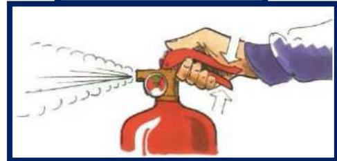
4. azionare l'estintore alla giusta distanza dalla fiamma, compatibilmente con l'intensità del calore della fiamma stessa
